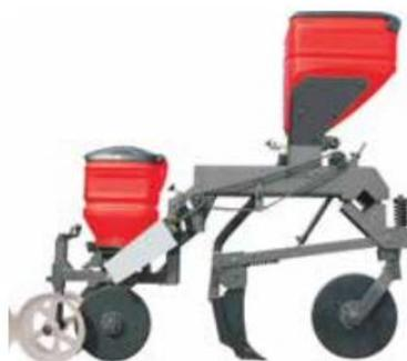
**Figura 2.** Exemplo de mecanismos mais comuns utilizados nas linhas de semeadura e adubação.
