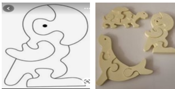
Figura 1 – Matriz do projeto e peças do projeto impressas em 3D.
