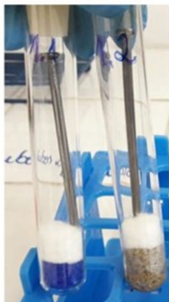
Tubo 1.1 – sílica gel, algodão, prego e rolha Tubo 1.2 – areia úmida, algodão e prego
