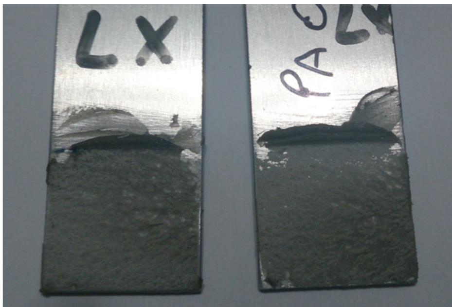
Figura 7. Corpo de prova LX-03 onde a falha foi do tipo coesiva do adesivo em todos os corpos de prova.
