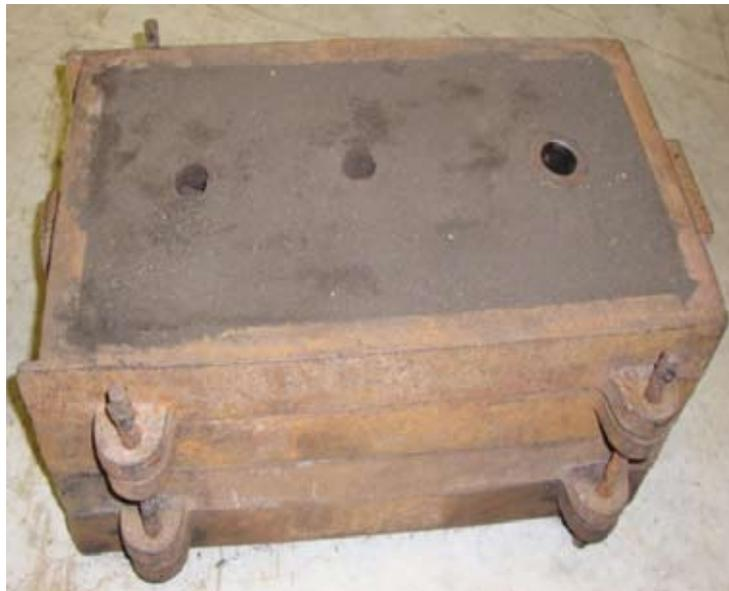
**Figura 2:** Aparato experimental evidenciando as três cavidades dos moldes, sendo, da esquerda para a direita: base de cobre, somente areia e lateral de aço.
